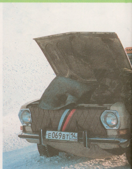
Sergej tilser bilens motor i minus 45 grader. Bemærk filtæppet og tildækningen af luftindtaget, der skal beskytte motoren mod de lave kuldegrader.
