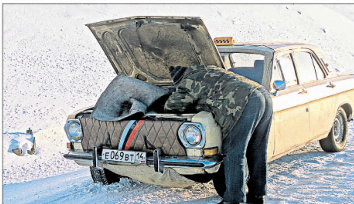
Drosjesjåfer Sergej må rett som det er ut for å sjekke motoren. Legg merke til filtteppet og tildekningen foran luftinntaket til beskyttelse mot kulden.
